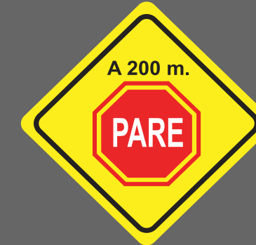
PROXIMIDAD DE SEÑAL RESTRICTIVA (pare)
